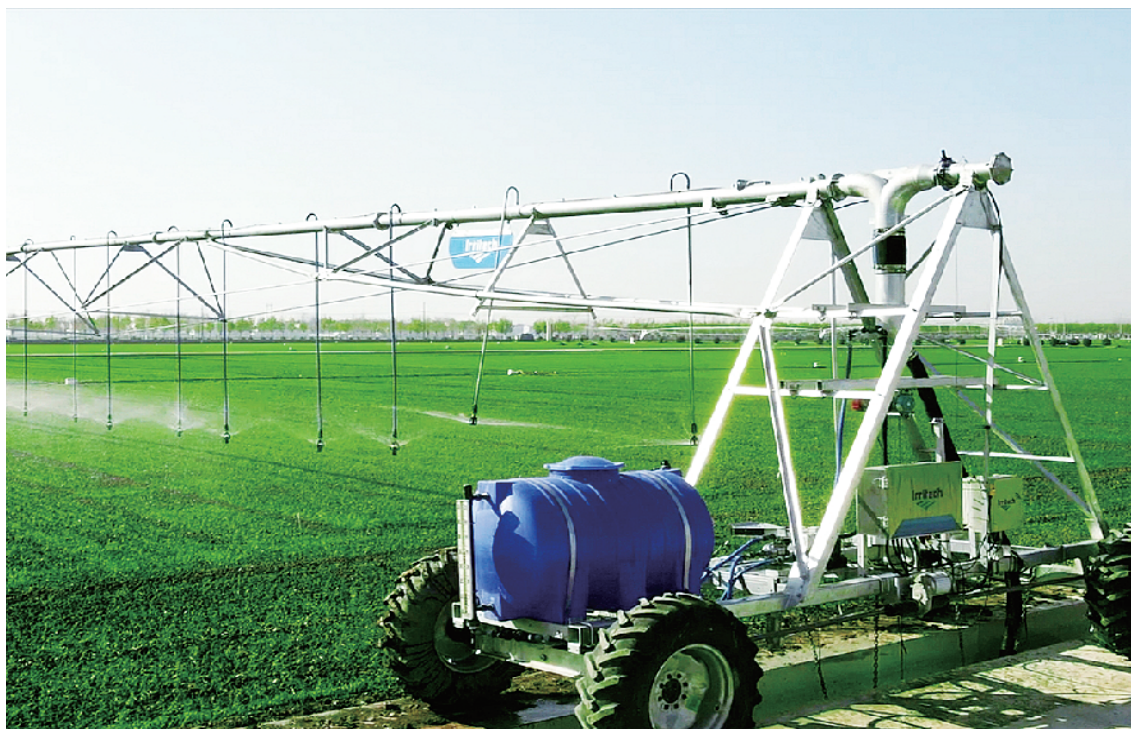
平移式喷灌机浇灌小麦的场景。
